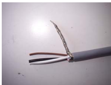
Detail B Odizolovaný kabel obalený stíněním
