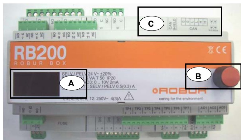
Obrázek 28 Rozhraní RB200. Displej, ovladač a svorkovnice CAN-BUS jsou zvýrazněny.
