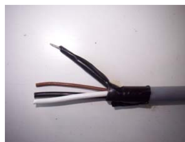
Detail C Použití izolační pásky
