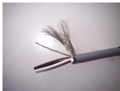
Detail A Odizolovaný kabel a stínění
