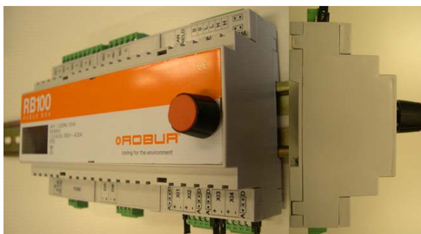
Obrázek 3 umístění zařízení na liště DIN (EN 60715)
